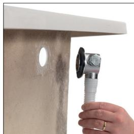
1. Umieść korek wanny na miejscu z tyłu wanny, upewniając się, że gumowa podkładka jest prawidłowo ustawiona między zespołem korpusu odpływu a ścianą wanny.
