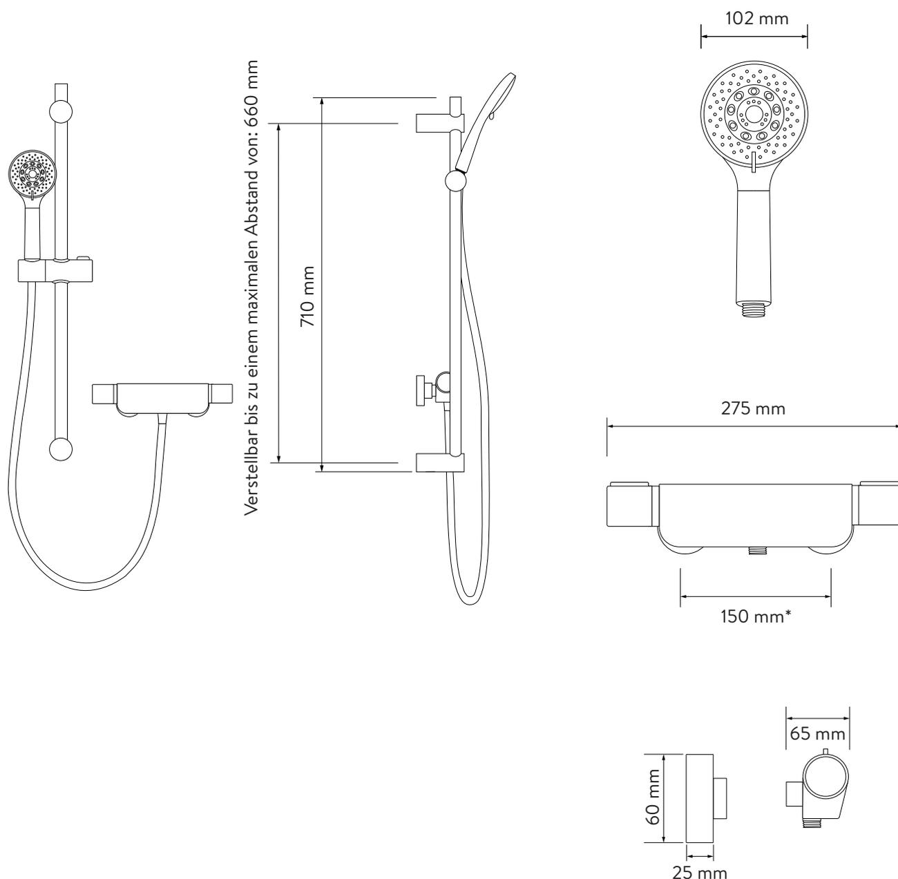
\*Bei nachträglichen Installationen können die Rohrmitten mit exzentrischen Ellenbogen (nicht im Lieferumfang enthalten) zwischen 130 mm und 170 mm angepasst werden.
