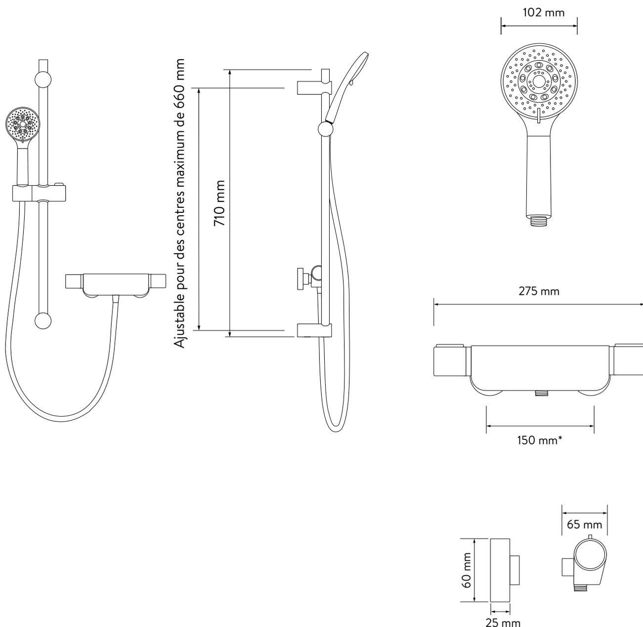
\*Pour les installations ultérieures, les centres des tuyaux peuvent être ajustés entre 130 mm et 170 mm à l'aide de coudes excentriques (non fournis).
