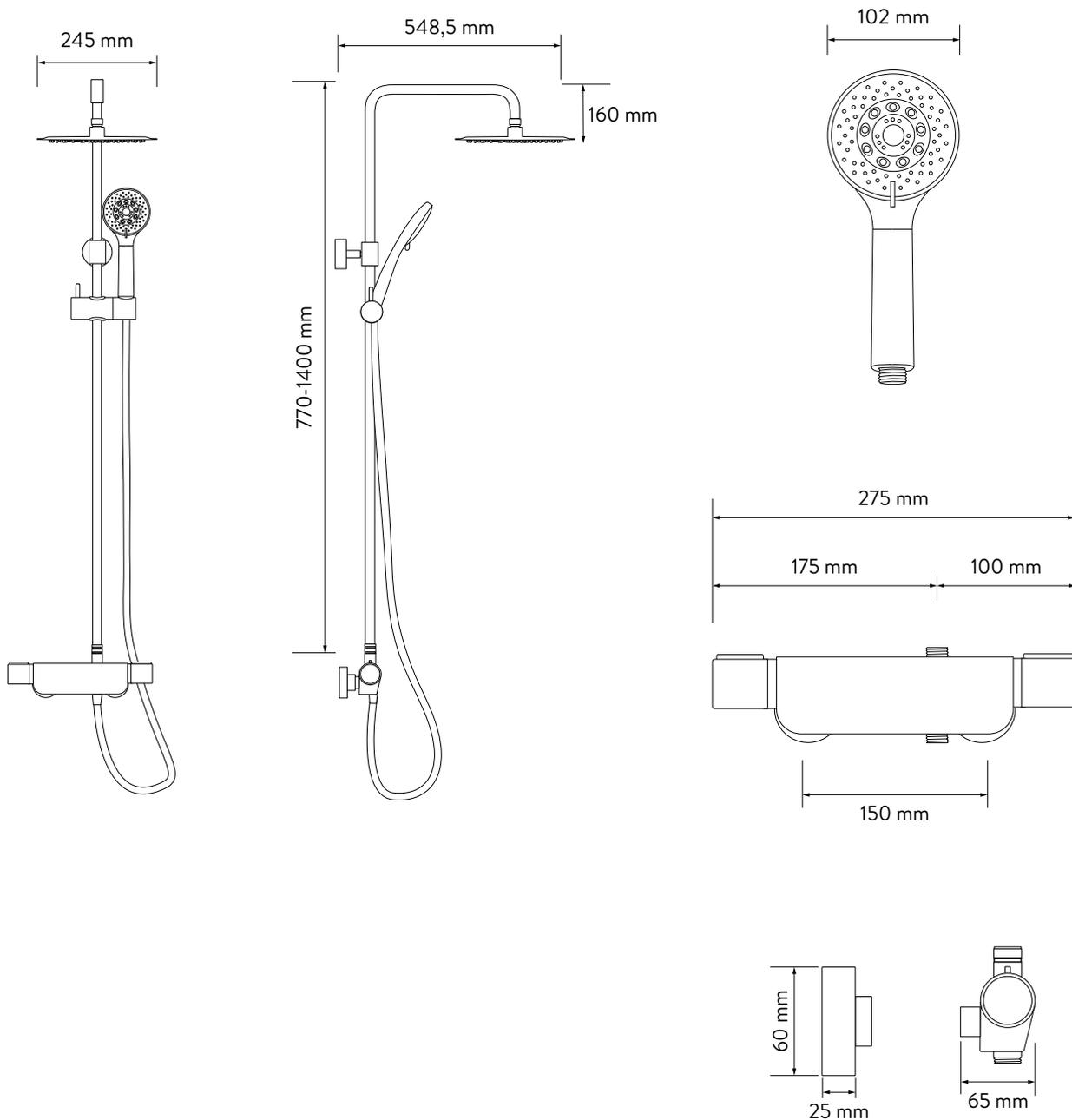
\* Pour les installations ultérieures, les centres des tuyaux peuvent être ajustés entre 130 mm et 170 mm à l'aide de coudes excentriques (non fournis). Numéro de la pièce : 911139.
